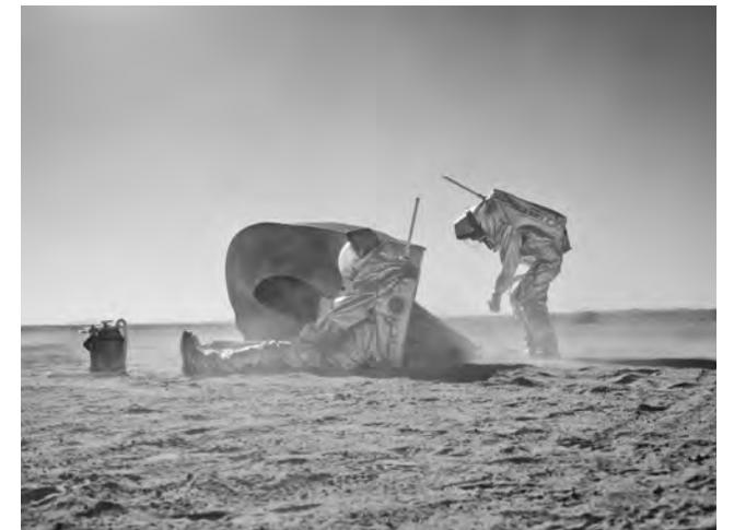
Abb. 2: **TU Deployable Shelter Prototype.** Studierende entwickeln und testen faltbares Habitat in Marokko; Foto: Zanella-Kux, OEWf
