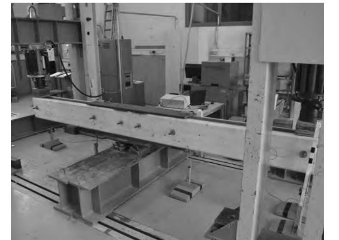
Abb. 4: Versuch zur Bestimmung der Knotensteifigkeit (Kragarmversuche); Foto: ITI
