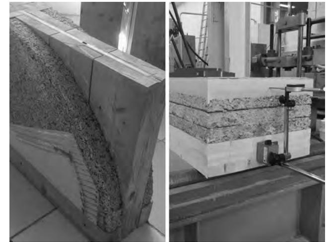
Abb. 1: Holz-Holzleichtbeton-Beton-Verbundquerschnitt: Wand und Decken; Foto: ITI / TU Wien
