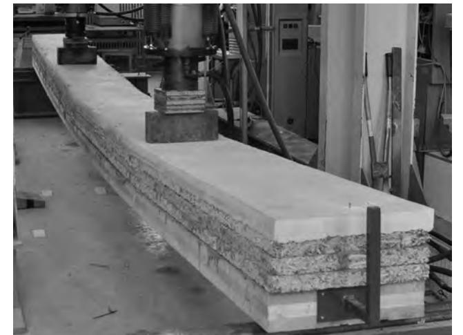
Abb. 2: Großbauteilversuche an Holz-Holzleichtbeton-Beton-Verbunddecken; Foto: ITI / TU Wien
