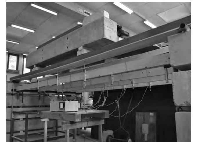
Abb. 5: Untersuchung des Langzeitverhaltens der Hybridträger; Foto: ITI
