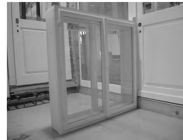
Abb. 1: Für Versuche mit Vakuumglas gebautes Mock-Up eines Kastenfensters; Foto: Verfasser (HFA, BPI)
