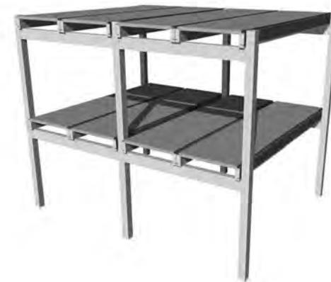
Abb. 1: Einsatz der Rippendeckenplatten beim mehrgeschossigen Bau; Grafik: ITI
